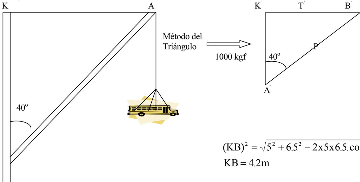
**Método del Triángulo Vectorial.** El punto B, está en equilibrio, bajo la acción de las tres fuerzas T, P y 1000 kgf. En consecuencia, las directrices de las fuerzas formarán un triángulo cerrado de lados paralelos a las direcciones respectivas y cuyas longitudes son proporcionales a sus módulos.
