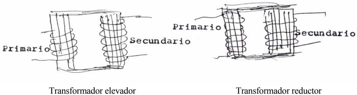
En las ilustraciones que se han hecho, vemos que en un medio rural se instala una turbina Pelton, la cual es movida por un salto de agua, y la corriente eléctrica es enviada a unas aldeas, situadas a enorme distancia. Un sistema de transformadores eleva la corriente desde 110 voltios, hasta 100,000 voltios. Al llegar al lugar donde será utilizada, se vuelve a bajar con un transformador reductor, hasta 150 voltios, voltaje que si, es manejable.
