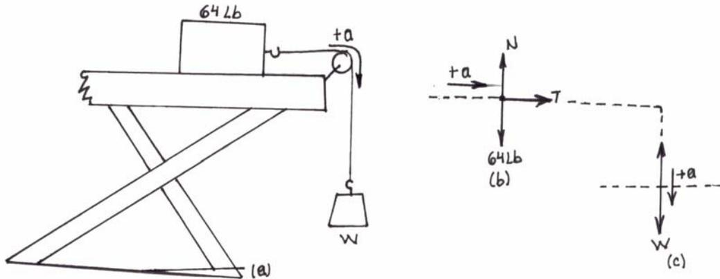
Dibuje diagramas de cuerpo libre para cada cuerpo del sistema, como se muestra en la figura b y c. Puesto que las fuerzas verticales en el bloque de 64 lb están equilibradas, la fuerza neta en el sistema total es simplemente el peso W. Así, aplicando la ley de Newton nos queda
