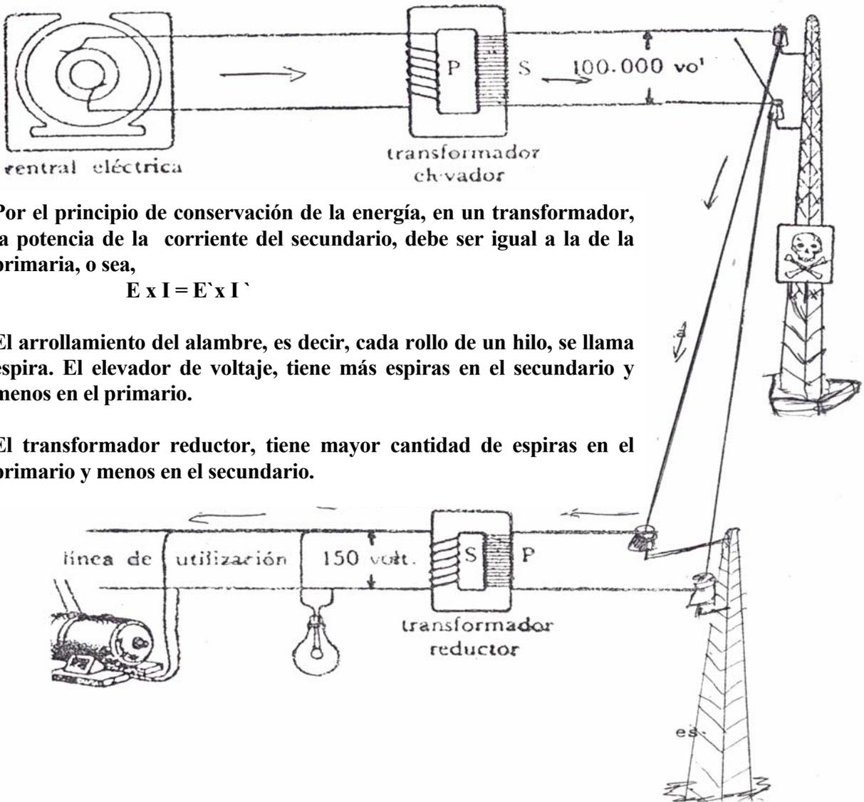
Por el principio de conservación de la energía, en un transformador, la potencia de la corriente del secundario, debe ser igual a la de la primaria, o sea,
