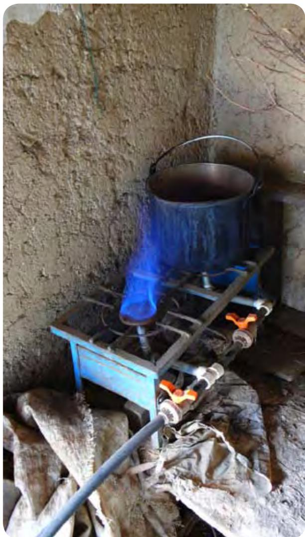
**Figura 2:** Cocina metálica adaptada para funcionar con biogás.
