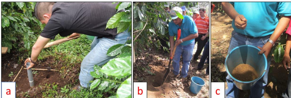
Figura 8. Extracción de la muestra de suelo, a) tubo pvc, b) palín y c) muestra de suelo. Fuente propia
