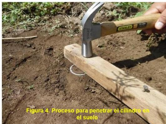
Figura 4. Proceso para penetrar el cilindro en el suelo
