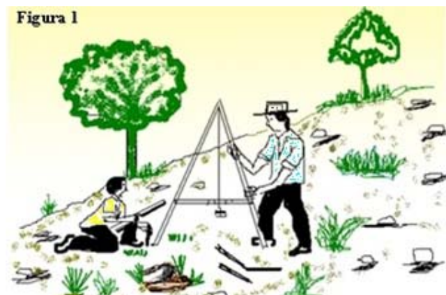
El nivel A y su utilización: las estacas pueden colocarse cada cinco medilas (cada 10m) o más frecuentes si el trazado curva o zigzaguea mucho.
