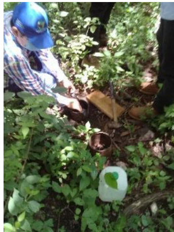
Foto 1. Prueba de infiltración
