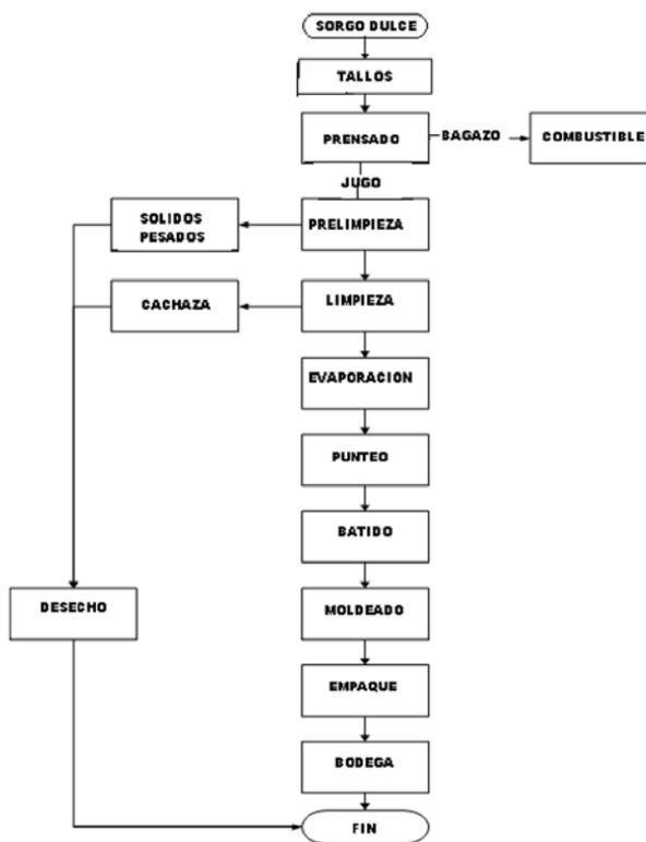
Figura 19. Diagrama de flujo para elaboración de panela a partir de sorgo dulce.
