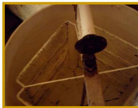
Figura 11. Centrifuga pintada inapropiadamente.
