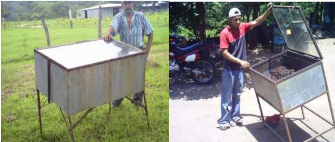
A la izquierda el derretidor en plena actividad, es foto sensible, concentra la radiación solar a través de una lámina de cristal que concentra alta temperatura interna, lo que permite separar la cera de las impurezas. A la derecha se puede notar el mismo derretidor, ya toda la cera ha sido derretida, quedando separadas la cera útil y las impurezas.
