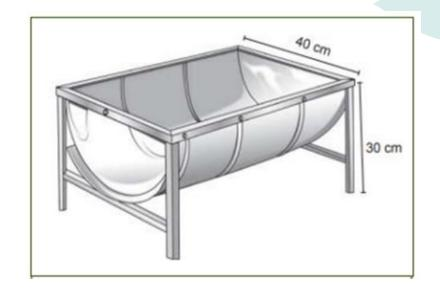
Las mitades de un barril metálico pueden convertirse en un bebedero eficiente
