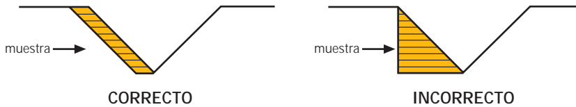
FIGURA 3: Recogida de muestras con pala. Fuente: Danés y Teixidor, 1983.
