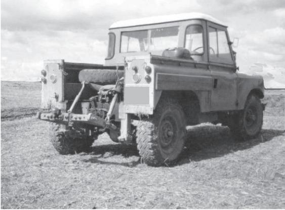
Figura 4 Agrovor ,o Land Rover adaptado para labores Agrícolas con un sistema de enganche de 3 puntos Para acople de implementos fuente farmPhoto.com
