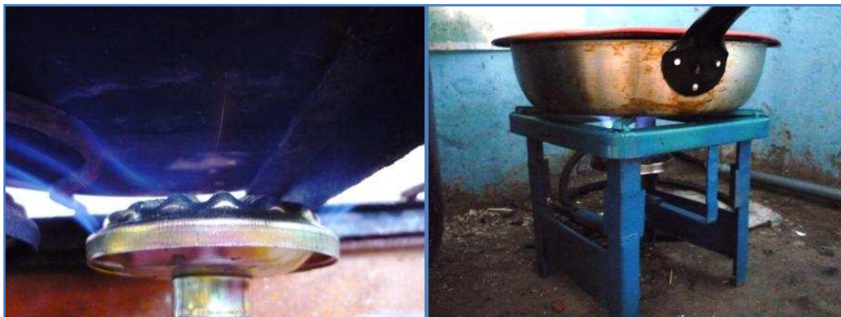
Imágenes del quemador en funcionamiento
