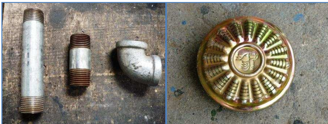
Piezas con la que se fabrica el quemador
