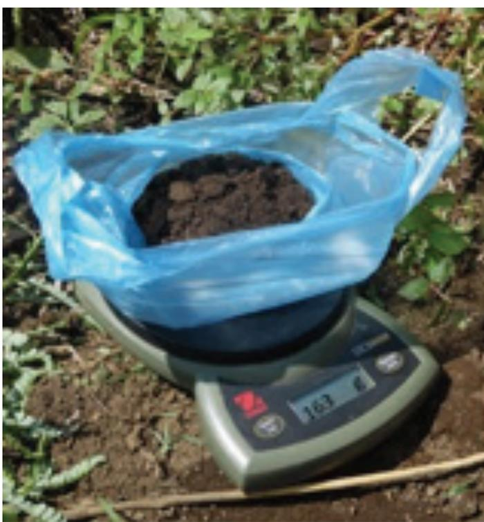
Figura 7. Pesaje del suelo contenido en el cilindro.
