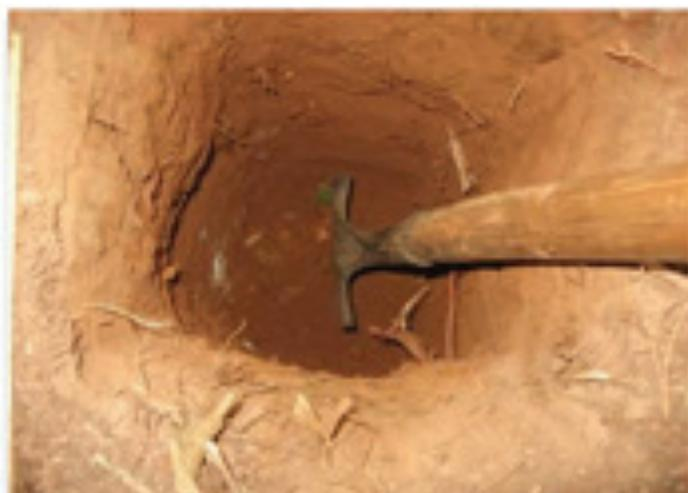
**Figura 1. Hoyo para medir la profundidad efectiva del suelo.**
