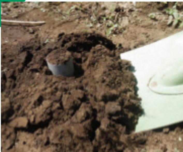
Figura 5. Sacar el cilindro del suelo.
