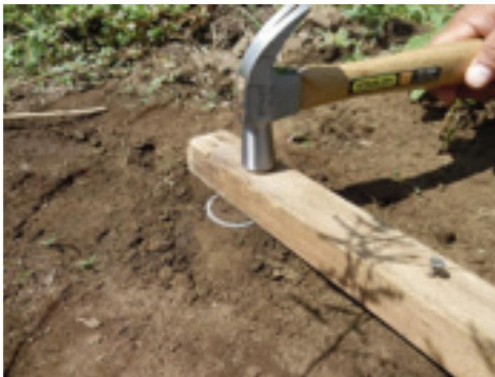
Figura 4. Proceso para penetrar el cilindro en el suelo.
