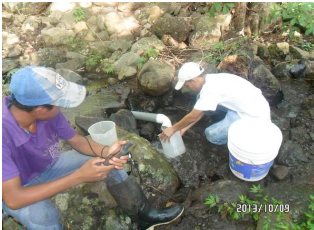
Foto 1. Aforo de un manantial con un tubo y codo de PVC. Foto: Izabá Ruiz, 2013.
