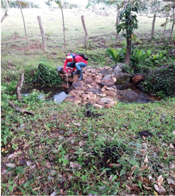
4 Medición de diques de piedra en la comarca Tierra Amarilla
