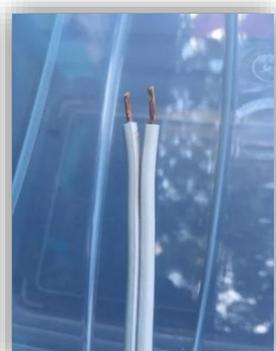
Figura 58. Retiro de goma para conexión de cepos 2
