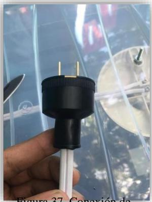
Figura 37. Conexión de alambre con enchufe 4
