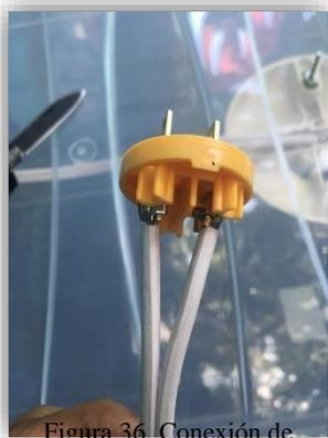
Figura 36. Conexión de alambre con enchufe 3
