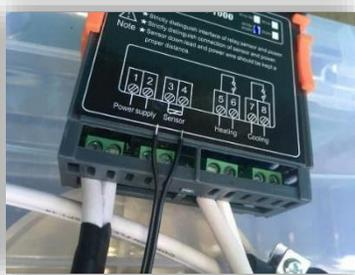
Figura 79. Conexión de sonda al termostato 1
