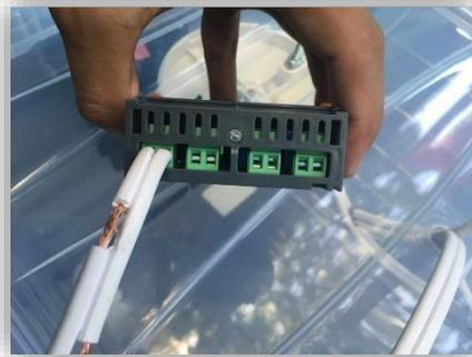
Figura 44. Termostato y sus conexiones
