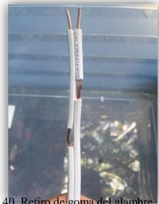
Figura 40. Retiro de goma del alambre dúplex para conexiones adicionales
