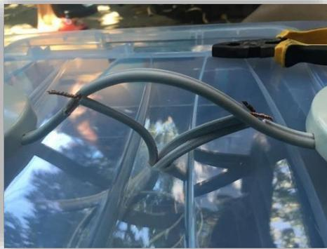
Figura 68. Conexión de entrada y salida de corriente a alambre de los cepos
