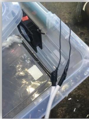
Figura 74. Cubrimiento con teipe los alambres del fan
