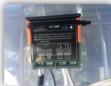
Figura 80. Conexión de sonda al termostato 2
