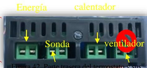
Figura 42. Parte trasera del termostato y sus cavidades
