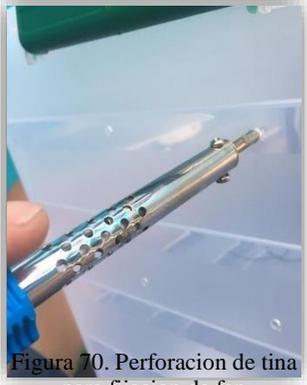
Figura 70. Perforacion de tina para fijacion de fan
