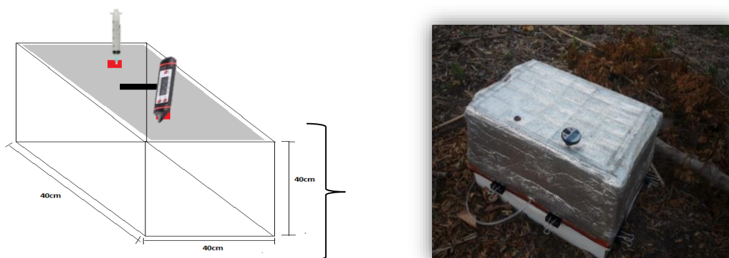
Figura 5. Parte superior: Cámara de polímeros con dos septum (redondos rojos) para la inserción de la jeringa y termómetro. Proyecto CIAT-UNA GEI 2014.
