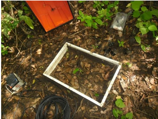
3. Medición de temperatura en campo, usando termómetro digital
