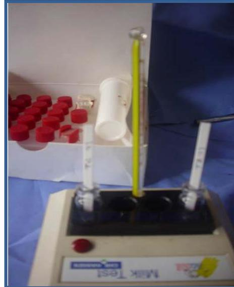
**Figura 7. Colocación de bandas marcadoras del reactivo - 2'**
