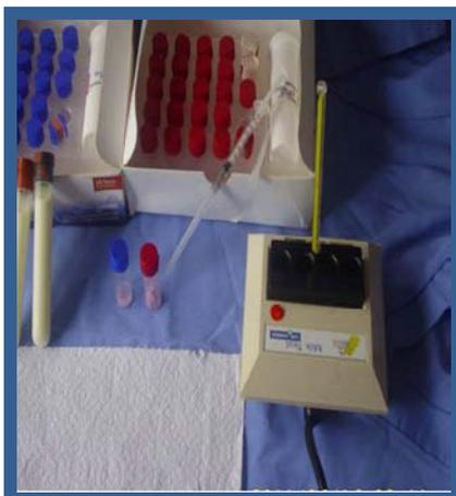
**Figura 4. Obtención de temperatura en el incubador (47°C)**
