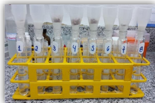
Fotografía 5. Segunda extracción (separación de la fase líquida de la sólida) Fuente: Arauz 2015
