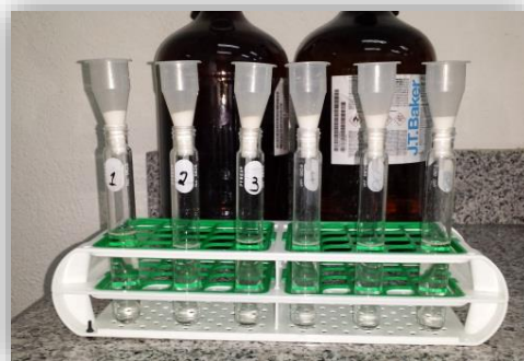
Fotografía 4. Columnas de alúmina preparadas Fuente: Arauz ,2015
