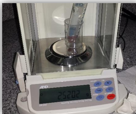
Fotografía 3. Peso de 2.5g \pm 0.2g de muestra Fuente: Arauz 2015
