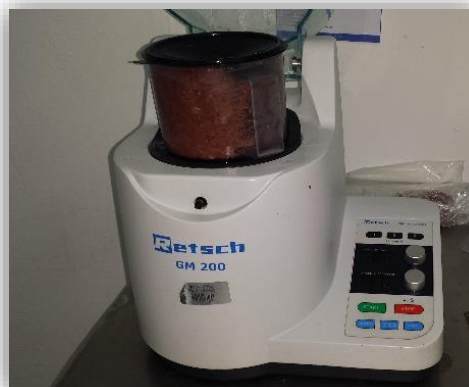
Fotografía 2. Homogenización de muestras Fuente: Arauz, 2015
