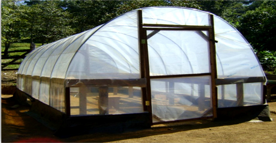
Anexo 2. Aspecto del pre-secador solar tipo domo por fuera.
