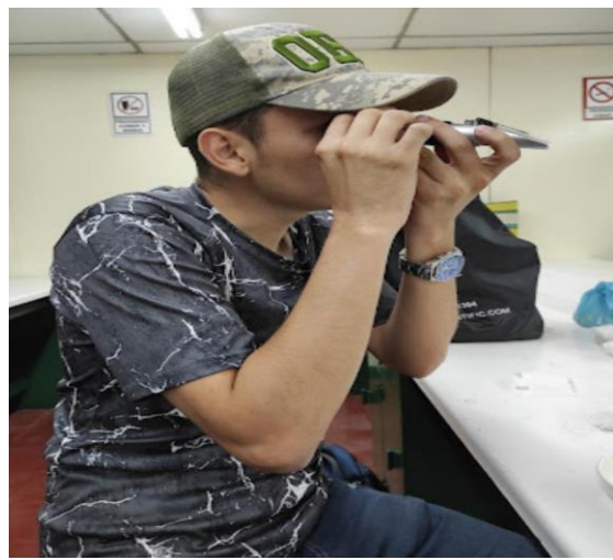
Anexo 6. Observación de muestra mediante el refractómetro
