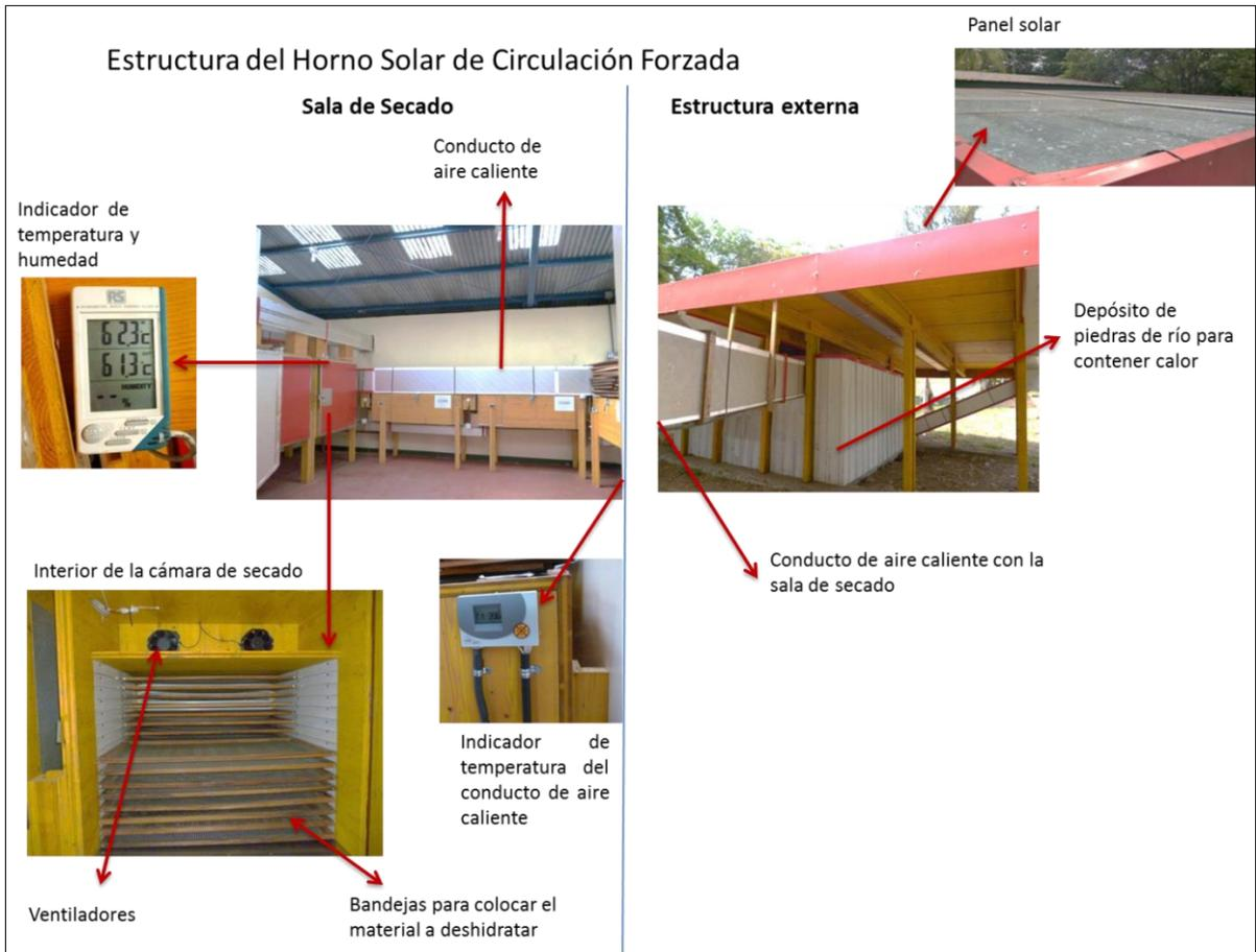
Figura 2. Estructura del Horno Solar de Circulación Forzada.
