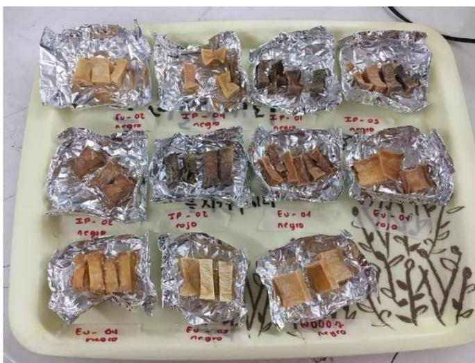
Figura 14. Muestras secas de papa de prueba de humedad y materia seca.
