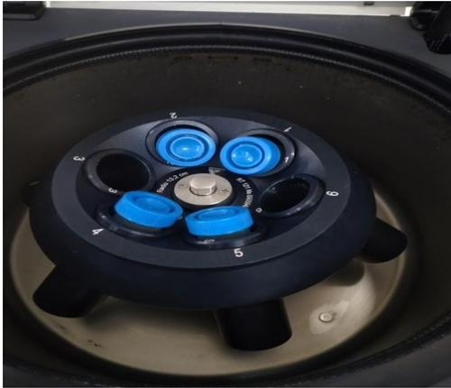
*Figura 6. Extracción de la Quercetina, fase de centrifugado*
