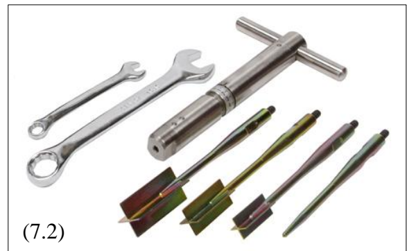
Figura 7. Modelo de Equipos Utilizados en Campo. (7.1) Penetrómetro cónico dinámico modelo H - 4202. 1A. para Ensayos de Penetración Estándar (SPT). (6.2) Kit de inspección de veletas modelo H – 4227 para mediciones de cohesión.
