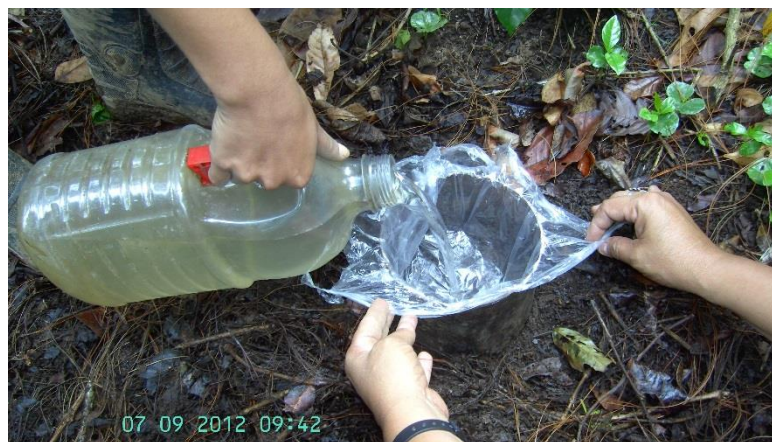
Figura 9. Agregando agua para prueba de infiltración.
