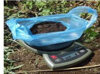
Figura 9. Pesaje del suelo contenido en el cilindro
