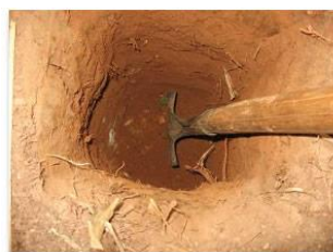
Figura 4. Medición de la profundidad efectiva del suelo
