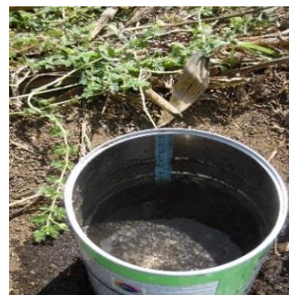
Figura 11. Midiendo el agua infiltrada
