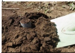
Figura 7. Sacar el cilindro del suelo
