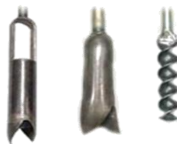
Figura 3. Barrenos para medir la profundidad efectiva del suelo
