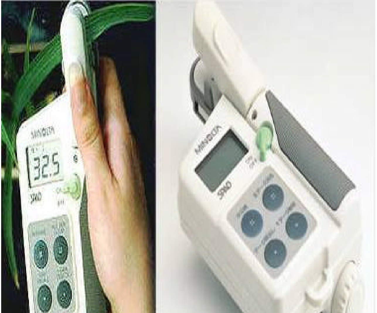
Clorofilometro Minolta SPAD- 502 en una hoja de sorgo.
