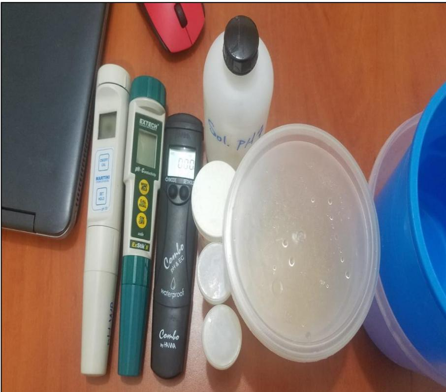
**Figura 17:** Multiparametricos de pH y Conductividad Eléctrica
