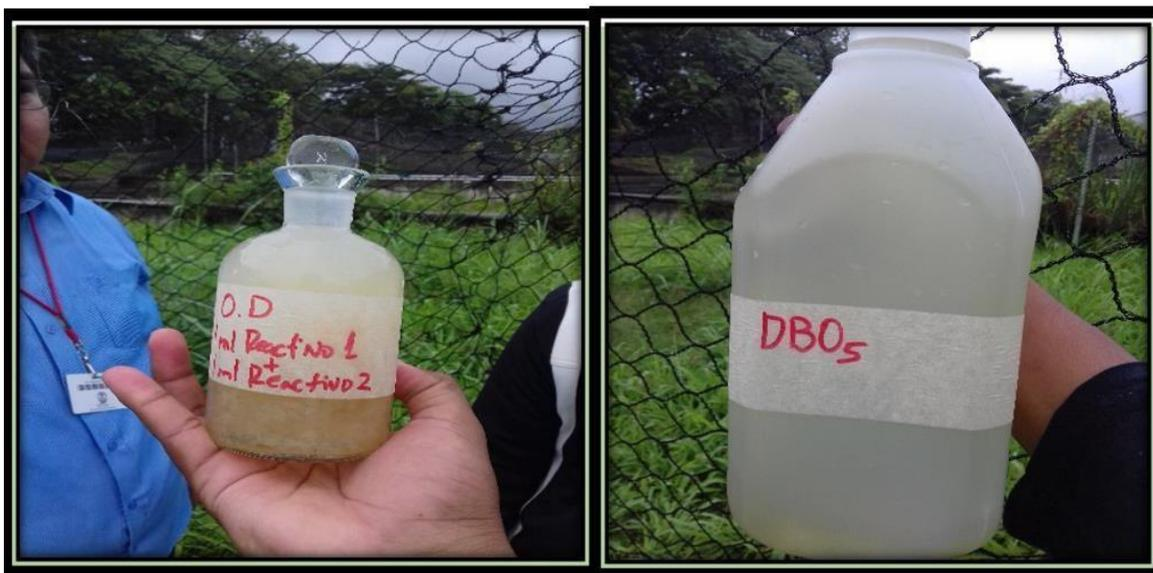
Figura 4. Recipientes para muestras de agua residual para los análisis de OD y DBO
