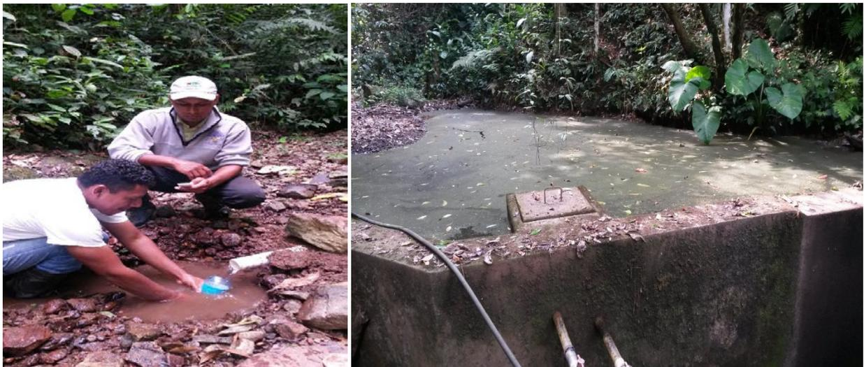
**Figura 10. Medición de caudal y área de captación e infraestructura de la fuente que abastece la comunidad Caratera, municipio El Tuma-La Dalia.**
