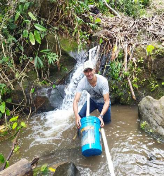
Anexo 10. Aforo en la fuente de alimentación e instalación de la bomba de ariete.
