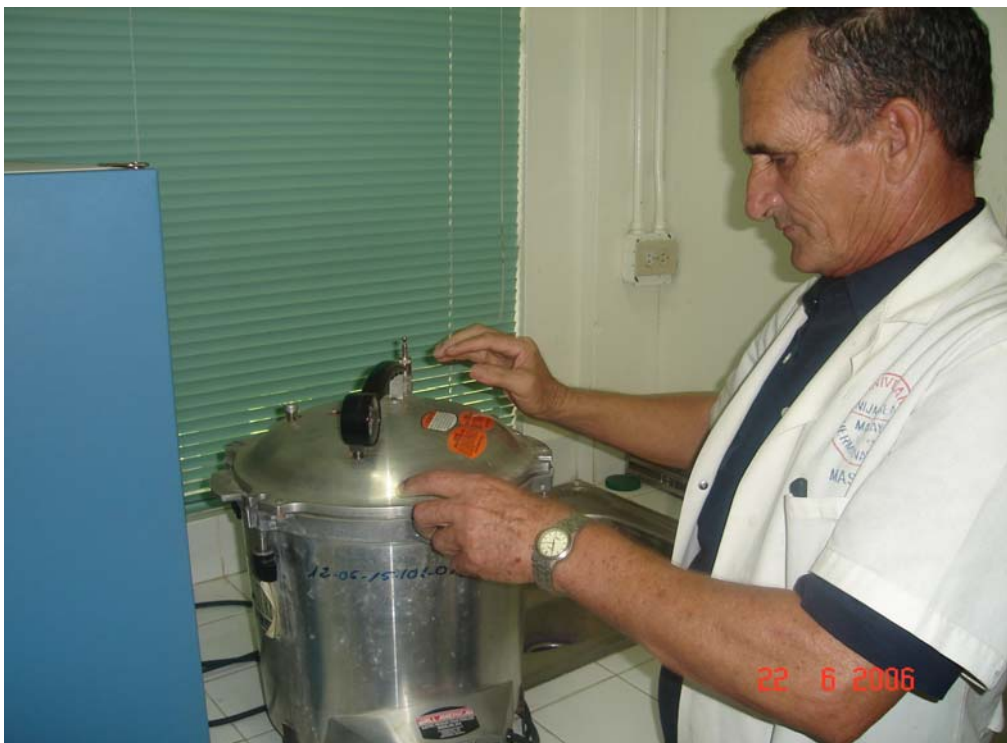
Foto 13 y 14: Esterilización en autoclave.
