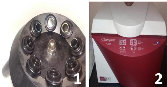
**Figura 3. Vista interna del centrifuga, (2) vista de frente de la centrifuga (Fuente: Lara, 2018)**
