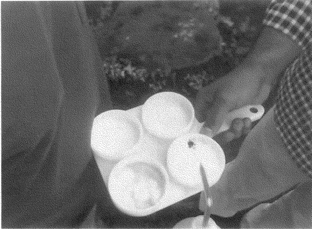
Figura 3 Adición de reactivo a la muestra de leche en igual volumen
