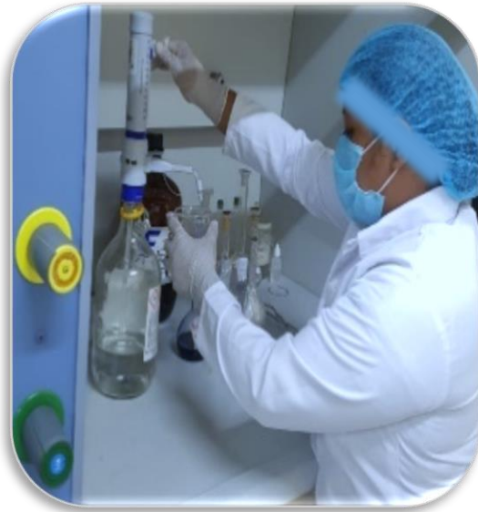
Figura 23. Protección adecuada (Uso de EPP)
