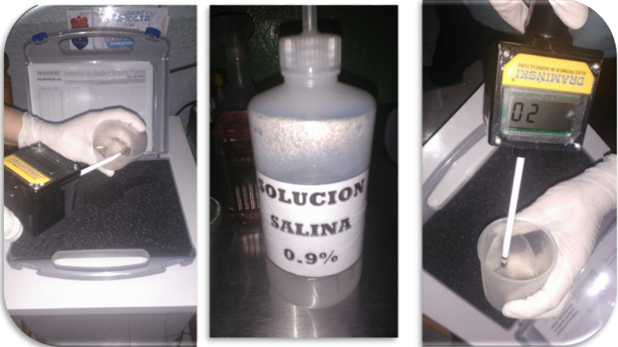
Figura 3. Calibración de detector de ovulación DRAMINSKI, Fuente: Rocha B., 2016
