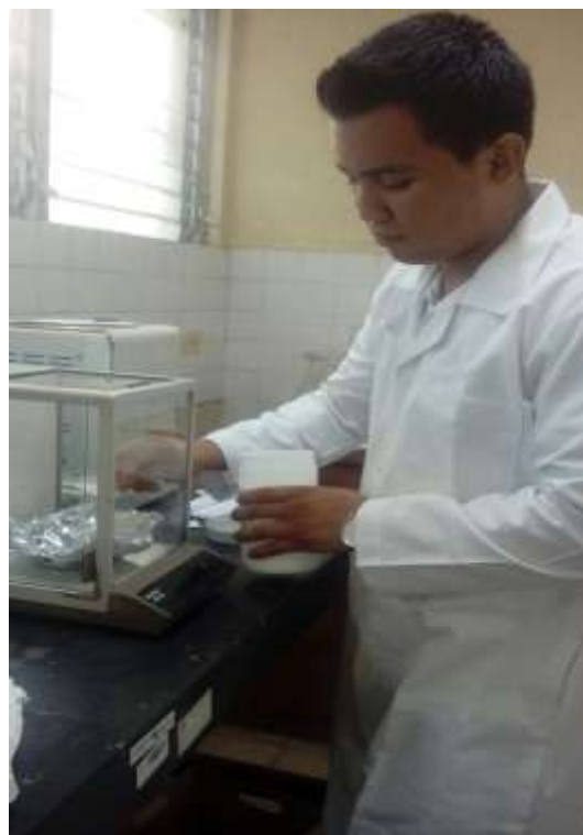
Pesaje de 430 ul de SDS
