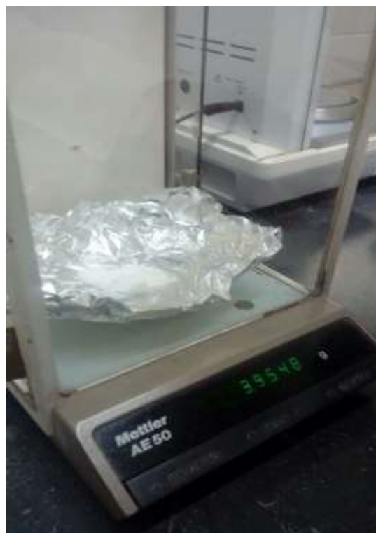
Pesaje de 430 ul de SDS
