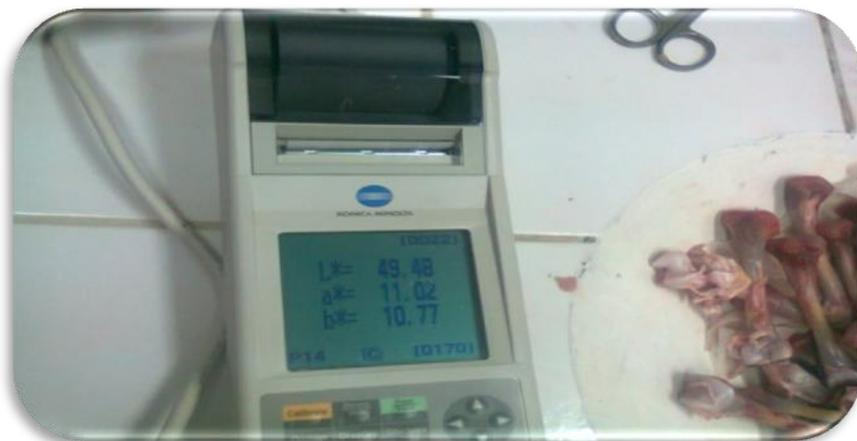
**Figura 9.** Análisis con Colorímetro Konica Minolta CR400
