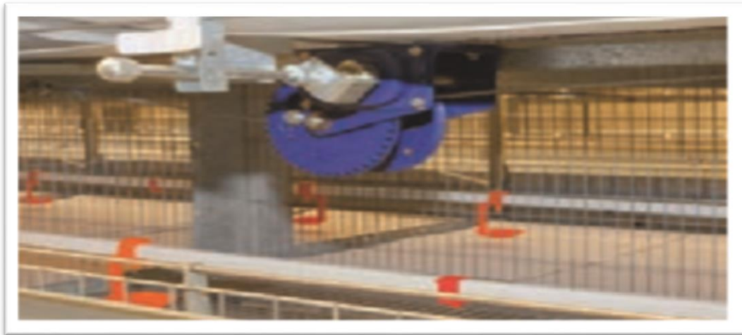
Figura 10. Torno para ajustar altura de bebederos Fuente: Big Dutchman (2017)
