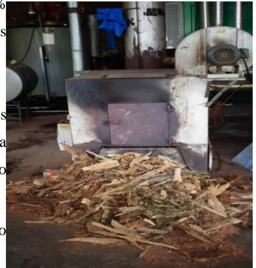
Figura 9. Desechos utilizados en horno industrial
