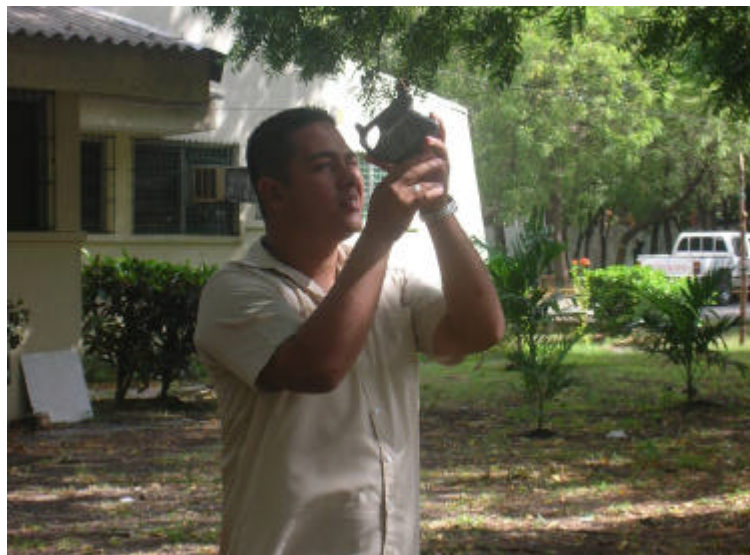
Figura 6: Medición de altura con pistola Blume-Leeis en la arboleda de la zona norte del campus de la UNA, 2007
