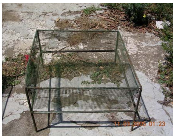
Gráfico 3.- Trampa metálica para captura de hojarasca
