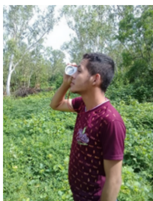
Figura 9. Medición de altura de los rebrotes utilizando el hipsómetro.
