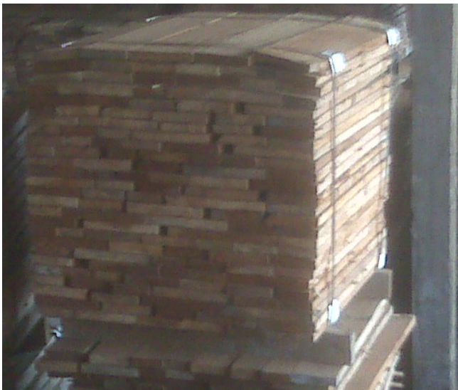
Figura 3. Bulto de madera aserrada para su cubicación. Foto tomada por Lam Oliveros Christian Shamir 2011.
