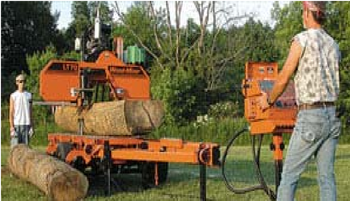
Figura 5. Aserrió portátil Wood-Mizer LT70. Fuente: Wood-Mizer Products, Inc. 2007.
