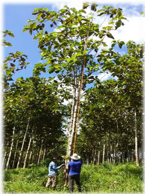
Figura 5. Medición de altura total del árbol mediante una vara metálica.
