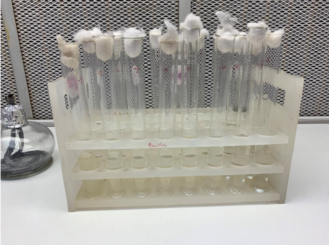
Anexo 10. Diluciones seriadas realizadas para obtener colonias del fungicida biológico Tacre Bacillus Plus®.
