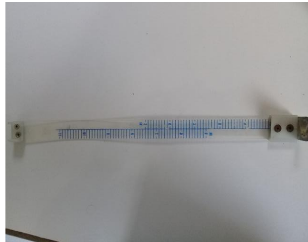
Anexo 12. Longitud del dedo tomada con calibrador de cinta plástica cristal de polietileno, con capacidad de 0 a 30 cm
