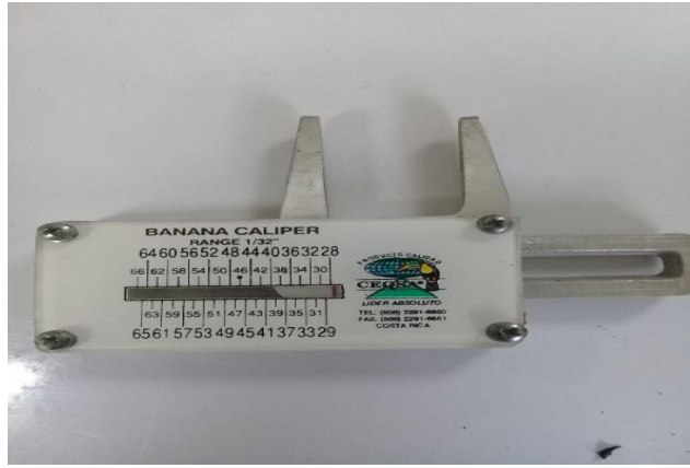
Anexo 11. Diámetro del dedo tomado con calibrador de variable con escala de 0-5 cm
