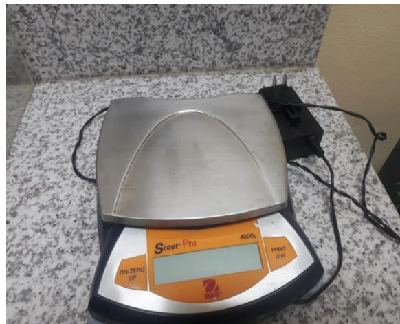
Anexo 13. Peso del dedo tomada con balanza electrónica Scout Pro DHAUS con capacidad de 4000 g
