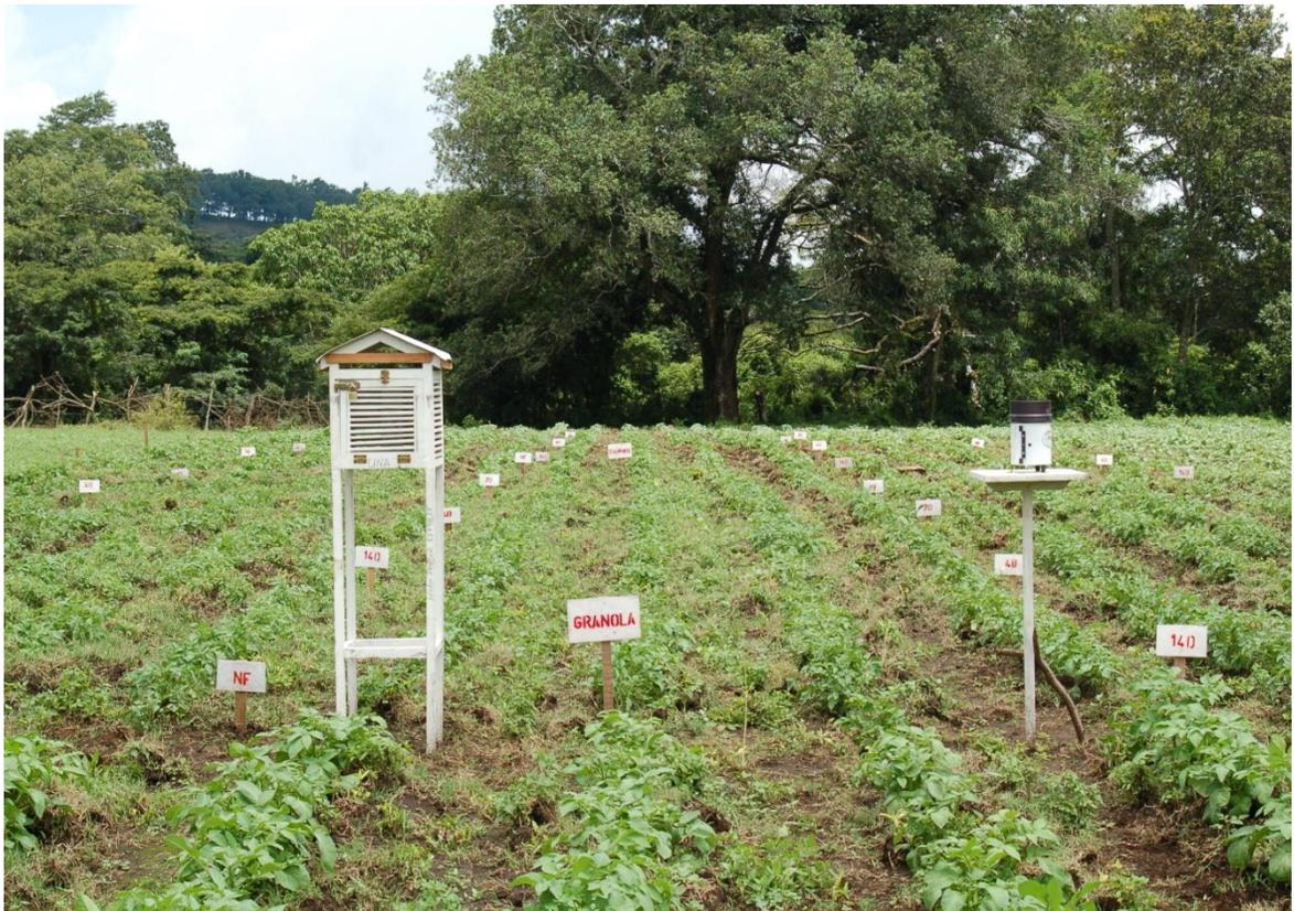
**Anexo 13. Establecimiento de sensores HOBO (Pro v2 temp/HR) y Pluviometro RG3-M (Precipitación).**
