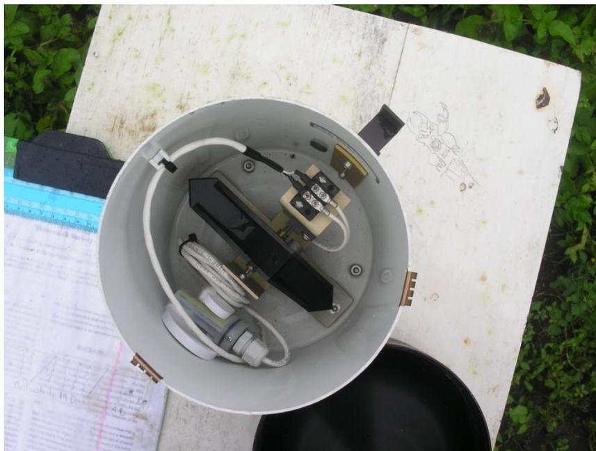
**Anexo 19. Ubicación del sensor Pluviómetro RG3-M**
